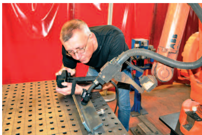
Ing. Peter Čelko pri ukážke laserovej pomôcky programovania zvarov Abidot
