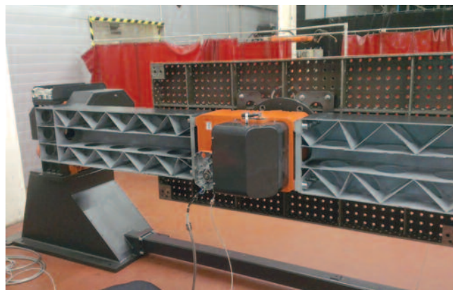
Spoločnosť JESEL navrhla dvojosové polohovadlo, ktoré je osadené dvomi prevodovkami ABB MTC2000 ku zvaraciemu robotu. Konštrukčná realizácia a výroba Koval Systems Beluša
